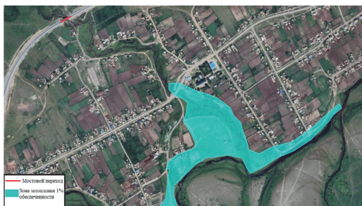
Рис. 8. Зона затопления от р. Ингоды при прохождении дождевых паводков 1 % обеспеченности в районе с. Хадакта
