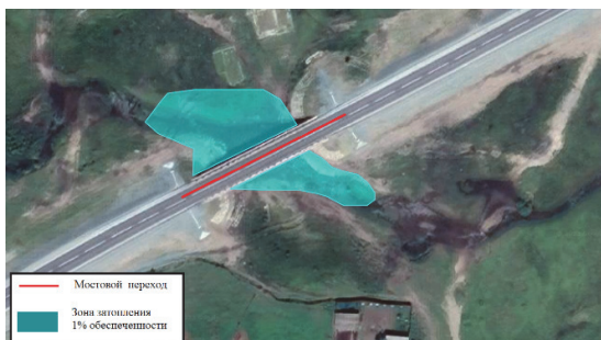
Рис. 5. Зона затопления от р. Санги Южной при прохождении дождевого паводка 1 % обеспеченности в районе мостового перехода
